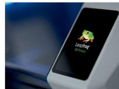
Bolt est équipée d'un grand écran tactile de 7" pour une meilleure expérience d'utilisation. Contrôlez facilement la toute dernière technologie qu'offre cette imprimante 3D à double extrudeur.
